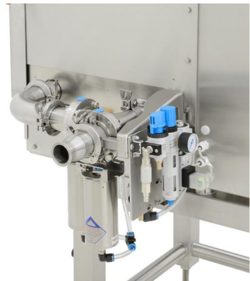
XRAY SHARK® XD08-H1-PIPE mit Luftdruckauswurfssystem.
