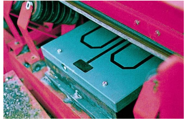
Metalldetektor SQ als Einzelsonde unter dem Förderband montiert.
